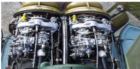
3. ábra. TV3-117 hajtómű, amely megtalálható a Magyar Légierő helikopterein is
