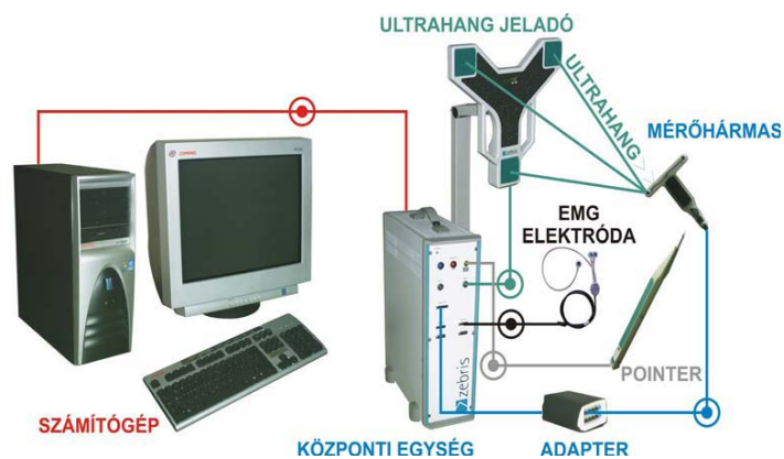
1. ábra. Az ultrahang-vezérelt rendszer összetevői
