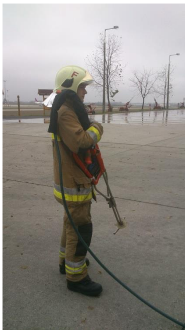
2. ábra A Liszt Ferenc Nemzetközi Repülőtéren található Repülőtéri Hivatásos Tűzoltó-parancsnokság egyik hivatásos tűzoltója egy tűzoltásra és fémfelületek átvágására is alkalmas eszközzel (Coldcut Cobra), saját fotó, 2013.
